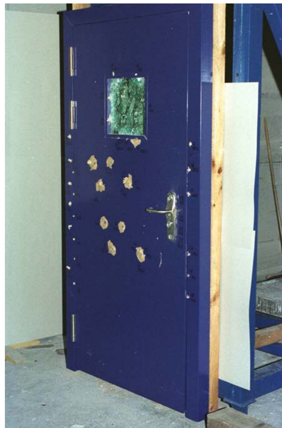
Abb. 2. Durchschusshemmende Tür, geprüft nach der Richtlinie für plattenartige Materialien.
