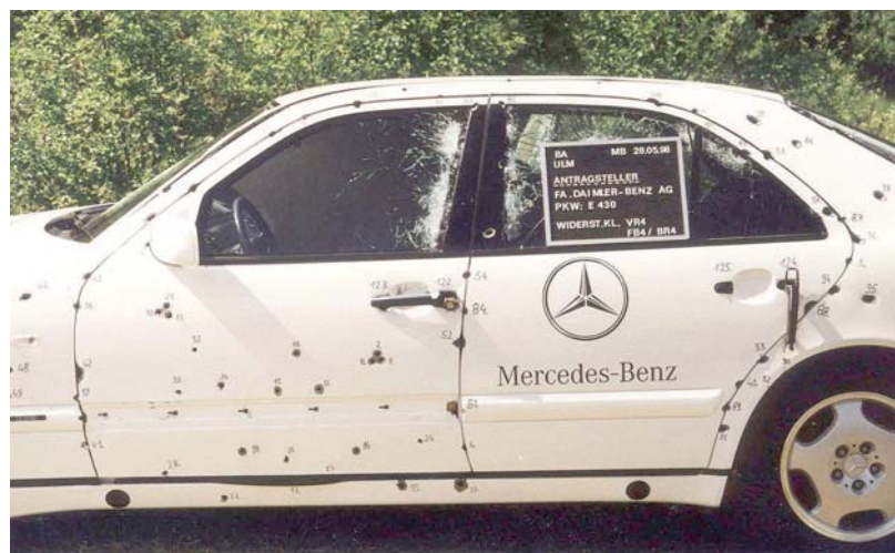
Abb. 1. Prüfung durchschusshemmender Fahrzeuge
