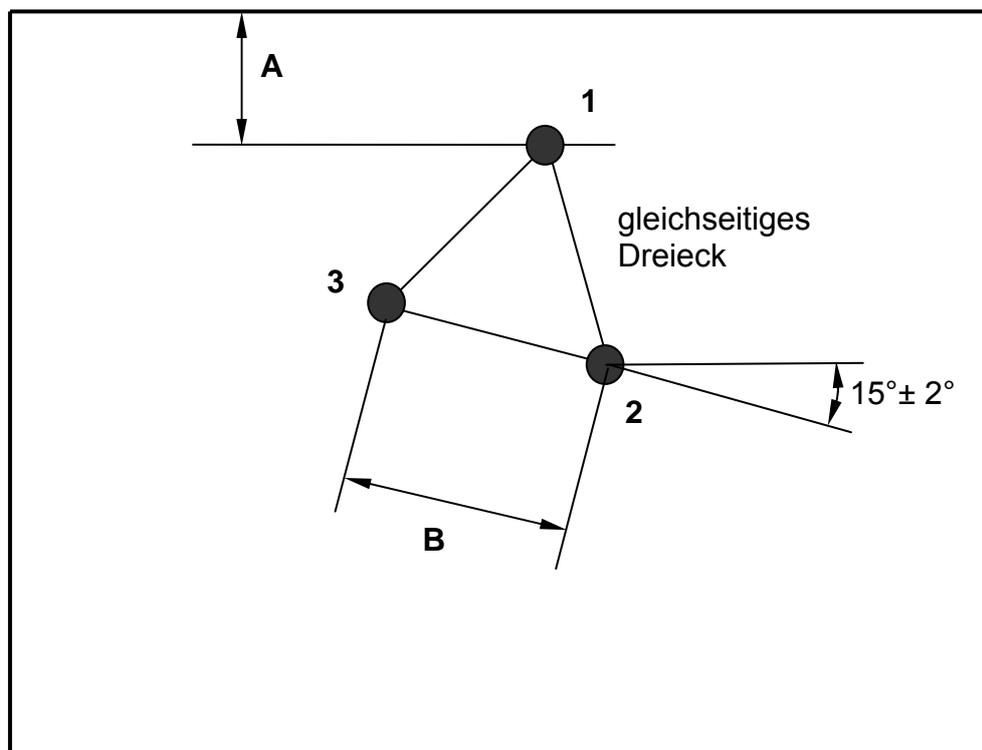
Die Prüfung hat entsprechend der Nummerierung zu erfolgen. Treffer Nr. 1 ist im Abstand von  $50 + 5$  mm (A) vom Rand des Schutzbereichs zu setzen. Die zwei weiteren Treffer sind entsprechend der Skizze im Abstand von mindestens 80 mm (B) untereinander und mindestens 50 mm vom Rand des Schutzbereichs zu setzen. Sicherzustellen ist, dass sich alle Treffer mehr als 100 mm von einer Innenkante des Plastikkastens befinden.
