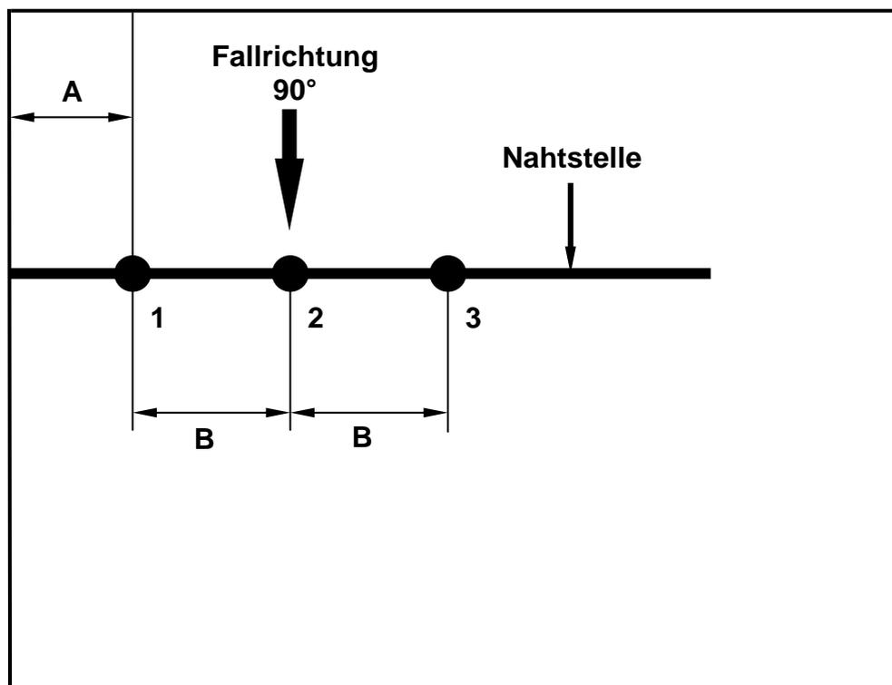
Die Prüfung hat entsprechend der Nummerierung zu erfolgen. Der erste Treffer ist im Abstand von 50 mm + 5 mm (A) vom Rand zwischen die Nahtstelle zu setzen. Die zwei weiteren Treffer sind entsprechend der Skizze im Abstand von mindestens 80 mm (B) zu setzen.
