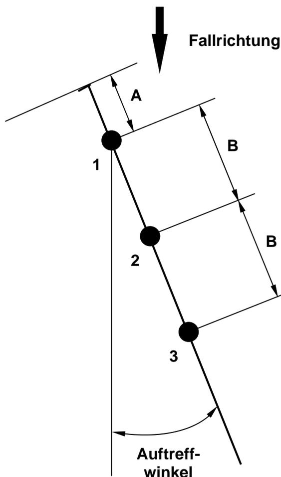
Die Prüfung hat entsprechend der Nummerierung zu erfolgen. Der erste Treffer ist im Abstand von  $50\text{ mm} + 5\text{ mm}$  (A) vom Rand zwischen die sich überlappenden Materialien zu setzen. Die zwei weiteren Treffer sind entsprechend der Skizze im Abstand von mindestens  $80\text{ mm}$  (B) zu setzen.
