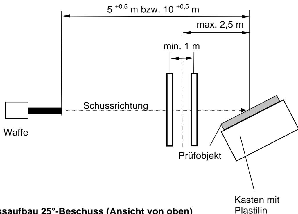
**Abb. 2: Messaufbau 25°-Beschuss (Ansicht von oben)**
