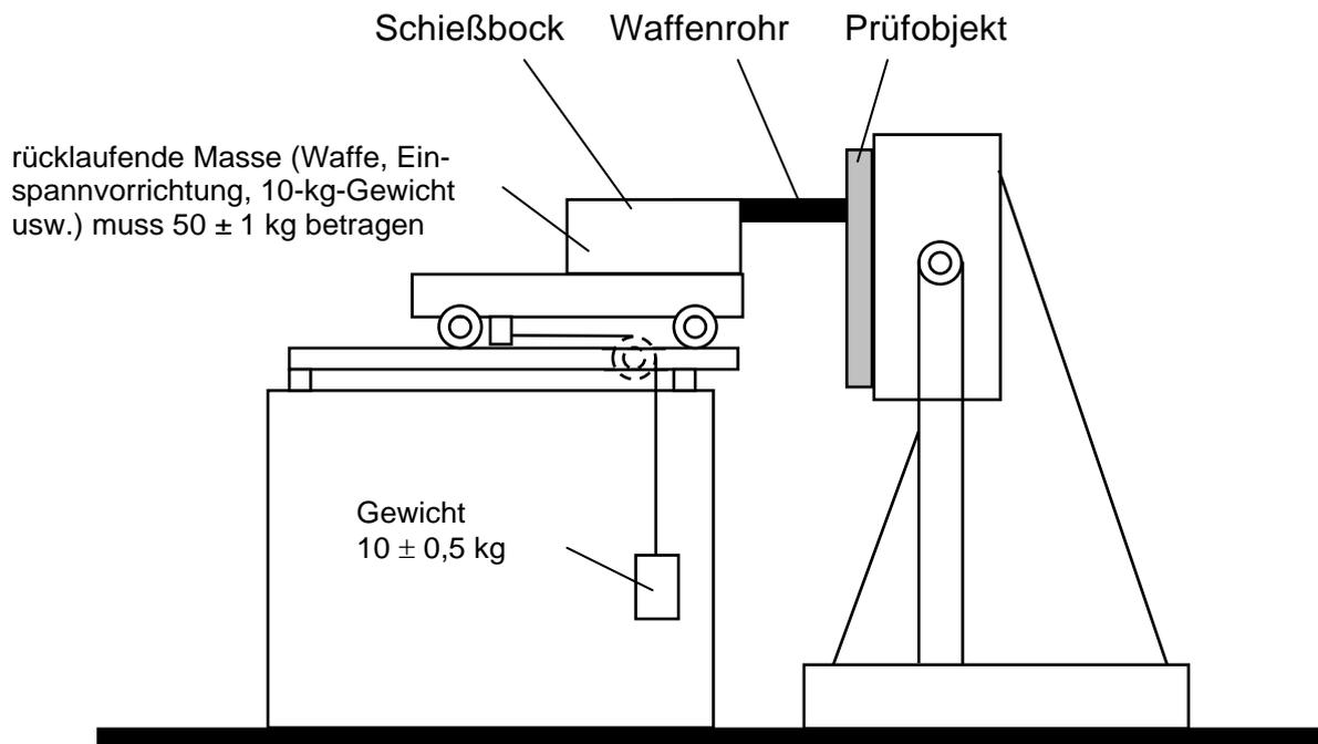
**Abb. 4: Prüfaufbau für aufgesetzten Schuss**
