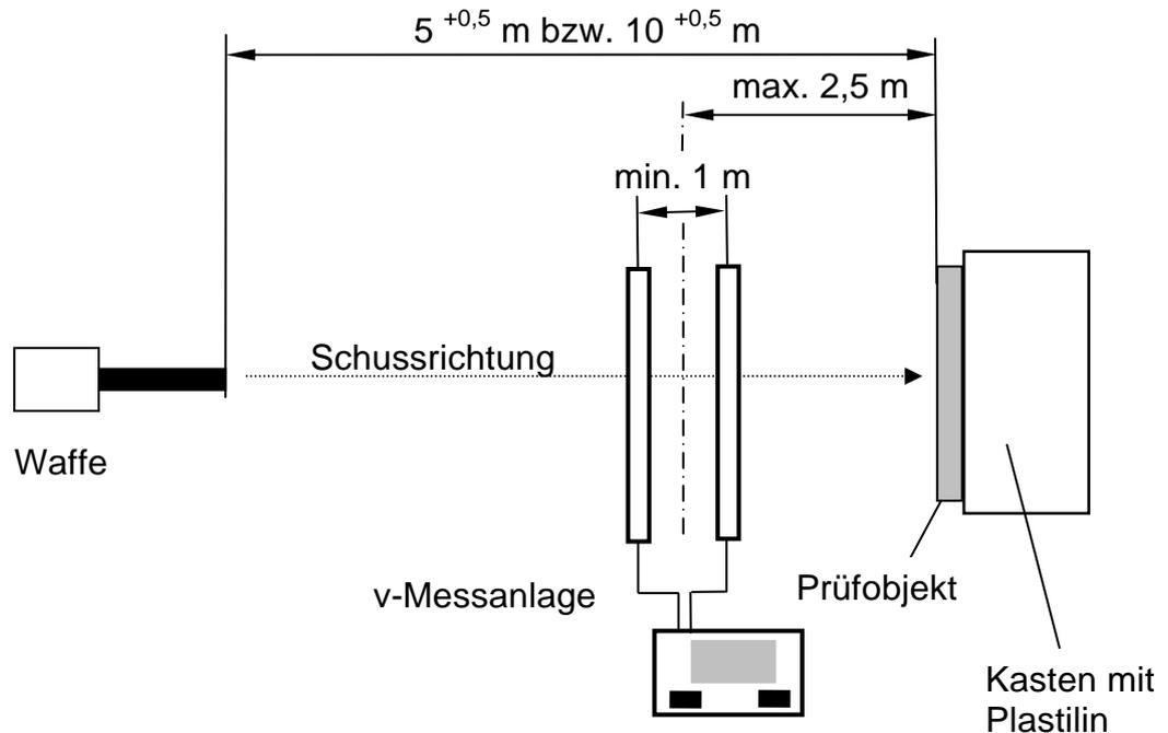
**Abb. 1: Messaufbau 90°-Beschuss (Seitenansicht)**
