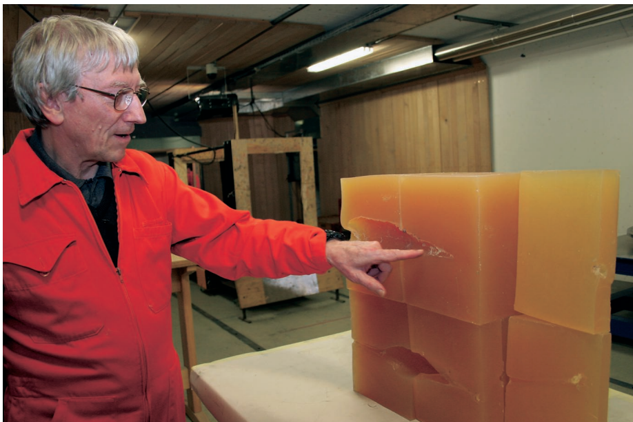
Ballistikexperte Beat Kneubühl erklärt die fatale Wirkung von Dum-Dum-Munition nach dem Testschüssen auf einen Seifenblock.
